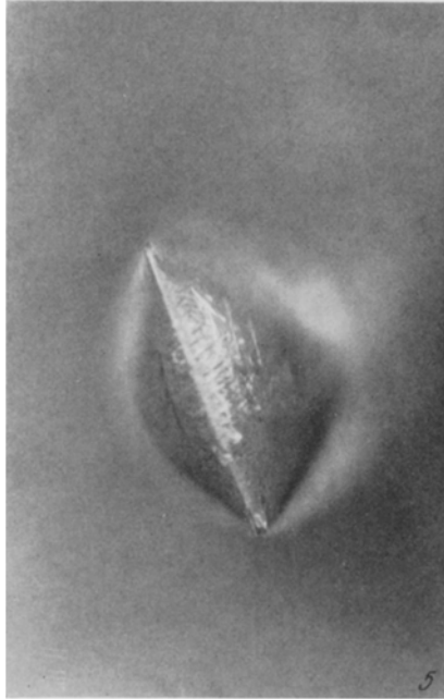
Abb. 5. Typischer Meißelbruch eines \langle 110 \rangle -Wolframeinkristalls, Meißelschneide in \langle 110 \rangle -Richtung
