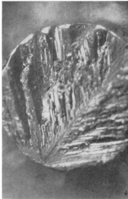
Abb. 4. Typische Bruchfläche eines \langle 110 \rangle -Wolfram-Einkristalls mit Zwillingsbildung auf \{112\} als Zwillingsfläche
